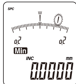
Medición de valor pico Modo mínimo (Min)
